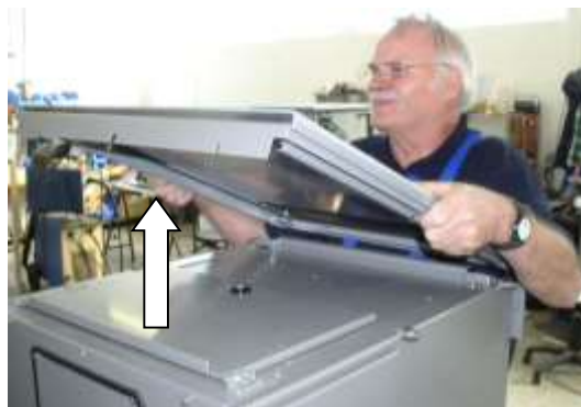
Fig. 11 : soulever le couvercle
