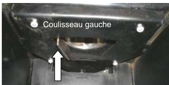
Fig. 92 : grille ouverte (position RO)
