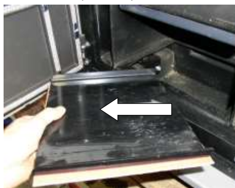
Fig. 108 : cache de l'accumulateur des gaz de combustion
