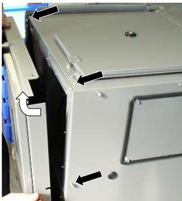
Fig. 13 : démontage habillage latéral
