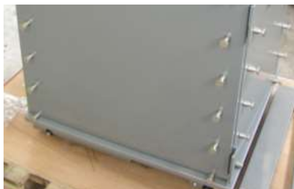
Fig. 30 : habillage avec boulons et vis vissés
