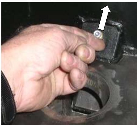
Fig. 118 : presser le levier de répétition vers le haut !
