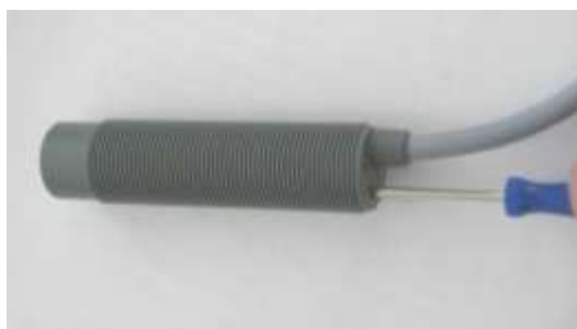
Fig. 69 : régler la sensibilité
