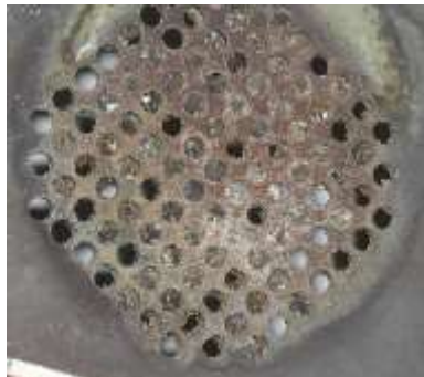
Fig. 100 : trous de la grille bouchés
