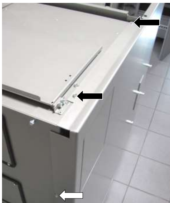
Fig. 16 : démontage habillage latéral ivo.safe®
