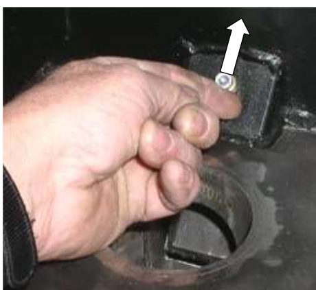
Fig. 113 : presser le levier de répétition vers le haut !
