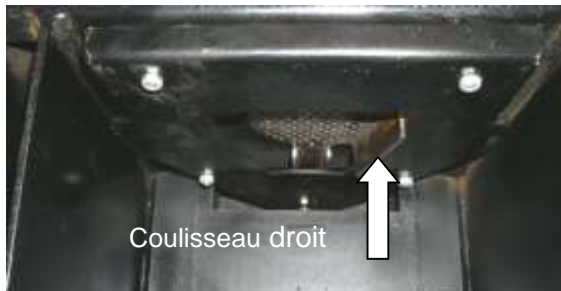
Fig. 91 : grille fermée (position RG)
