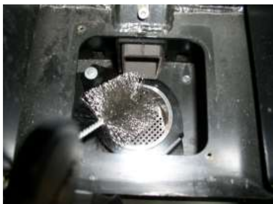
Fig. 122 : nettoyer la grille pivotante
