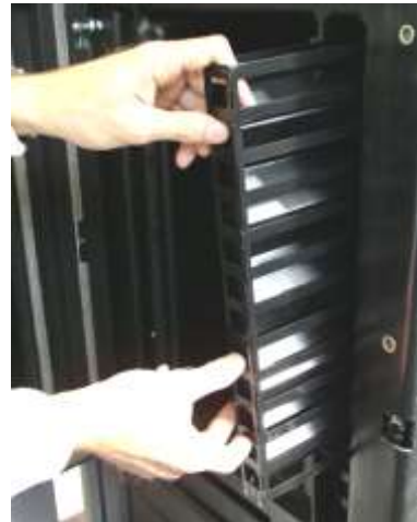
Fig. 136 : retrait de l'épuration de l'échangeur thermique
