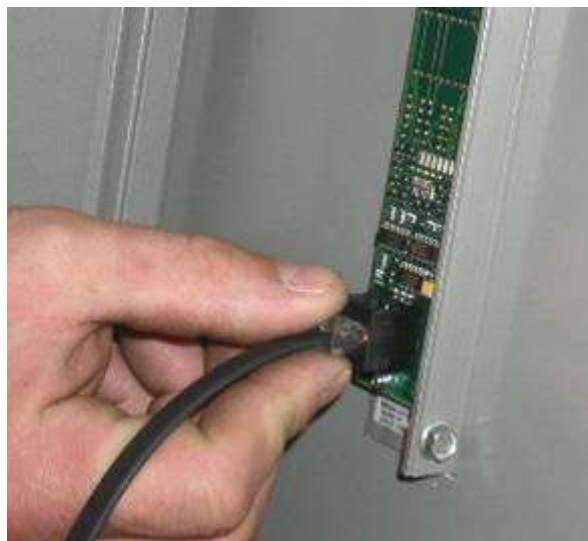
Fig. 15 : câble du panneau de commande
