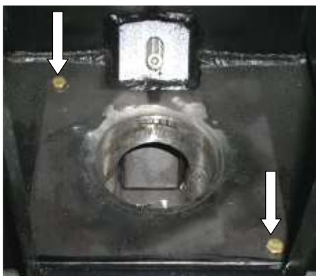
Fig. 112 : vissages pot brûleur
