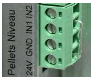
Fig. 60 : entrée niveau de pellets
