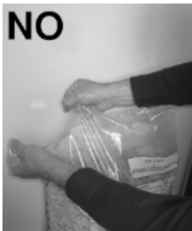
Fig. 26 - Ouverture incorrecte du sac des granulés
