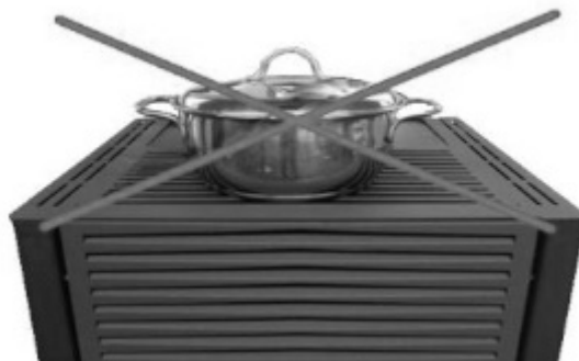
Fig. 31 - Ne pas obstruer les fentes d'air
