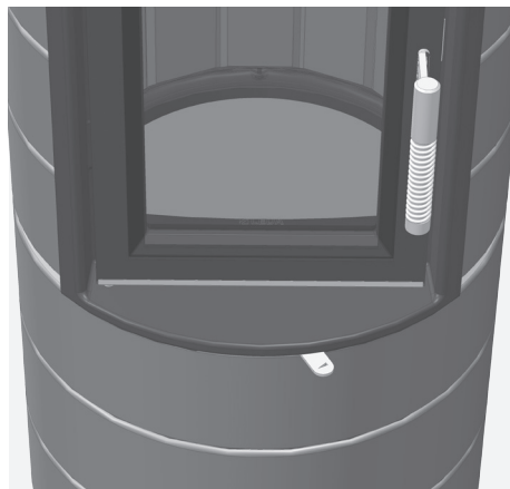
Fig. 4.4 Registre d'air de combustion : à droite = complètement ouvert
