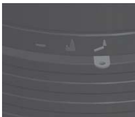
Fig. 4.18 Régulateur d'air de combustion tout à droite : air complètement ouvert
