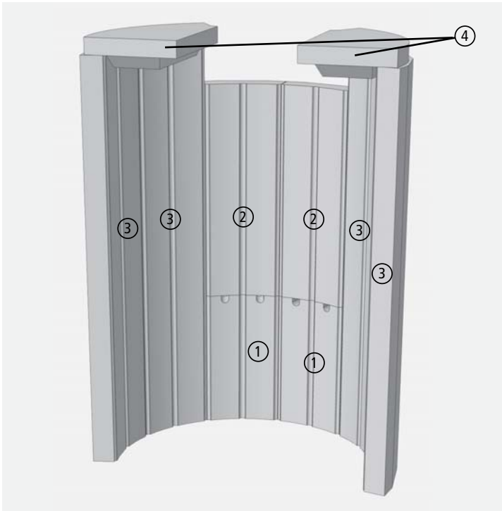
Fig. 5.1 Revêtement de la chambre de combustion
