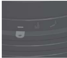
Fig. 4.14 Régulateur d'air de combustion tout à gauche : air complètement fermé
