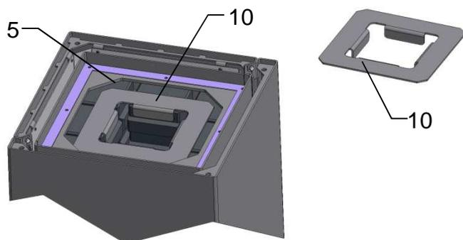
Positionner le cadre de fixation (10) sur les pierres d'accumulation (5) pour qu'elles restent bien dans leur position.
