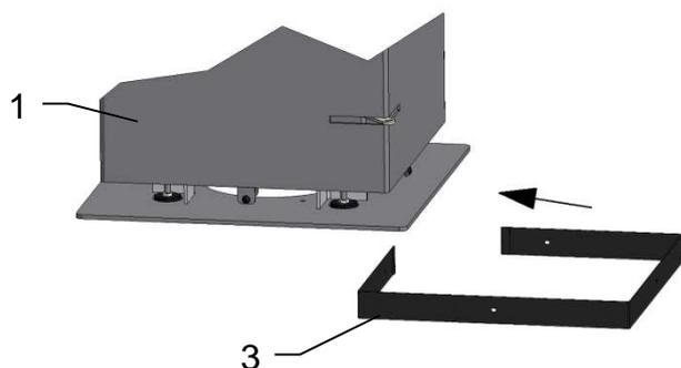
Fixer le cache du socle (3) avec 4 vis à six pans (5) au poêle (1).
