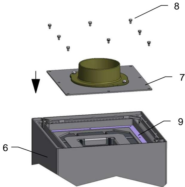
Refermer le compartiment (6) hermétiquement avec le couvercle (7) en faisant attention que le joint (9) n'est pas détérioré et positionné correctement.
