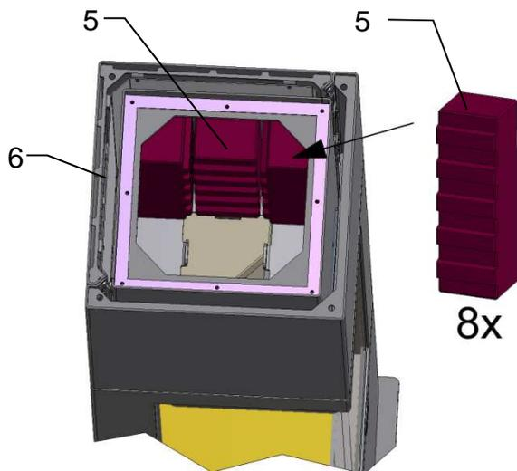
Insérer les pierres d'accumulation (5) dans le compartiment du bloc d'accumulation (6) comme illustré avec les renforcements vers l'intérieur.
