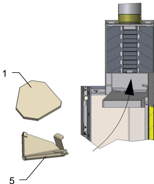
Pour nettoyer les tuyaux et le bloc d'accumulation, démonter les deux déflecteurs (1) et (5)
