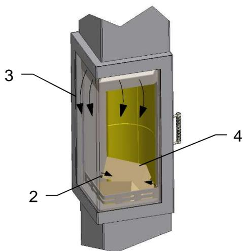
L'air nécessaire pour la combustion sera réglé par la manette de réglage d'air (1). L'air primaire (2) et l'air secondaire (3) sont réglés avec une seule manette (1).
