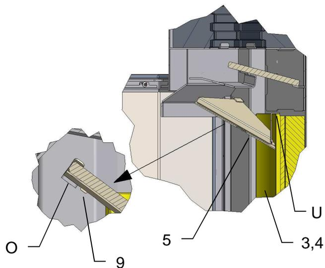
Le déflecteur (5) doit reposer sur le support supérieur (O) et à l'arrière avec la languette (U) sur les pierres réfractaires (3, 4).
