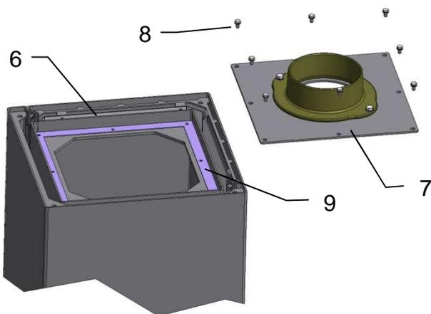
Pour installer ces pierres d'accumulation (5) il faut d'abord dévisser les 8 vis à six pans (8) pour pouvoir enlever le couvercle (7) du compartiment bloc d'accumulation. Le tout en faisant attention de ne surtout pas abîmer le joint (9).
