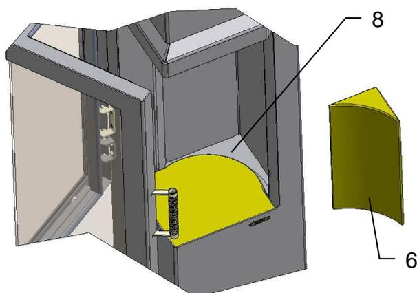
Insérer une pierre d'angle (6) dans l'angle arrière de la chambre de combustion (8).
