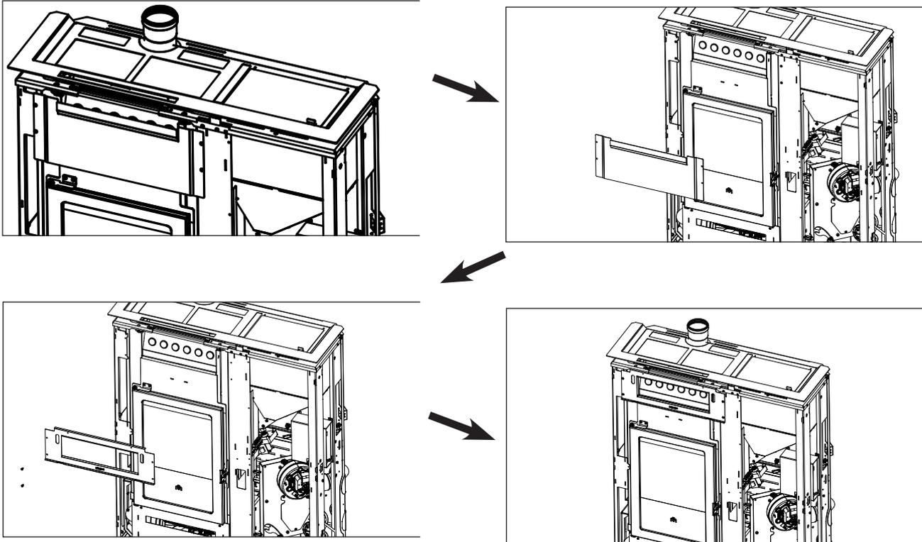
2. Placer les pièces métalliques (2,3,4,5) en partant de la partie inférieure gauche (3) (en regardant le produit de face). Chaque élément est encastré puis fixé avec des vis.
