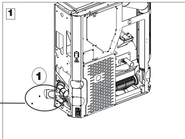
2. Enlever et remonter vers le côté le coude blanc (2), de 6 cm de diamètre, inséré par encastrement.
