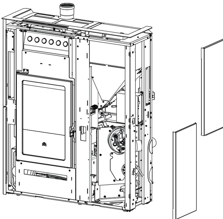
posizionare a incastro i sei componenti in pietra. Dettaglio in figura sotto Non ci sono regolazioni.
