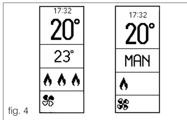
**In caso di Programmazione Oraria Attivata**, 3 e 4 sono sostituite dalla programmazione oraria del giorno con al centro il set attuale (figura 5) e in alto a destra il livello di temperatura.
