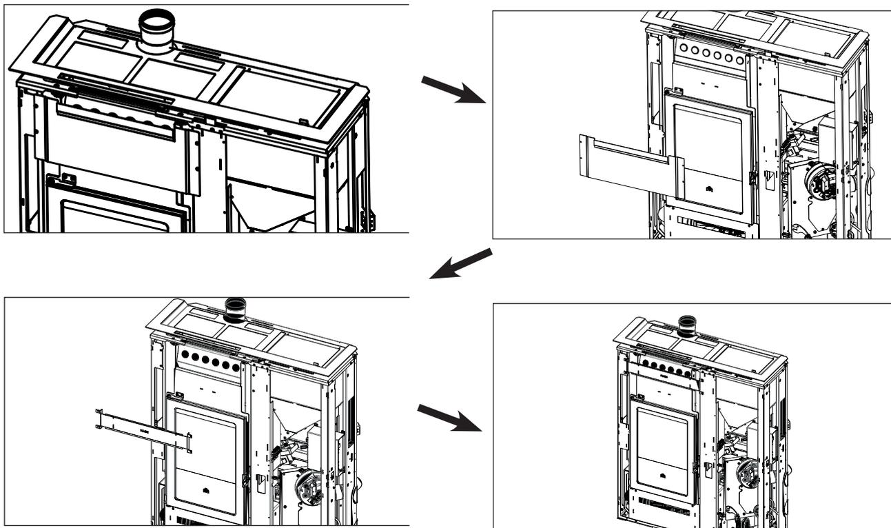
posizionare i quattro elementi laterali in metallo (7,8,9,10) partendo dal basso. Ogni elemento è a incastro, e poi fissato con viti.
