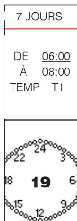
Pour modifier l'horaire d'allumage, appuyer sur les touches « +/- ». L'enfoncement prolongé permet un défilement rapide.
