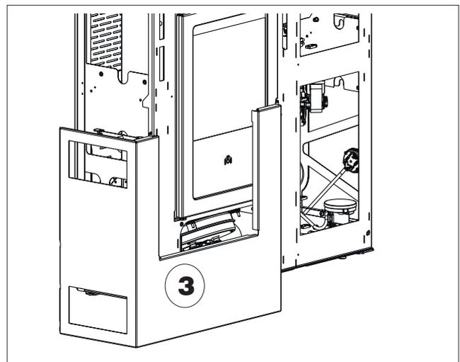
3a. Préparer les pattes (voir figure ci-dessous) et visser les 4 supports à la structure pour la fixation des céramiques, en utilisant les vis indiquées dans le tableau ci-dessous.
