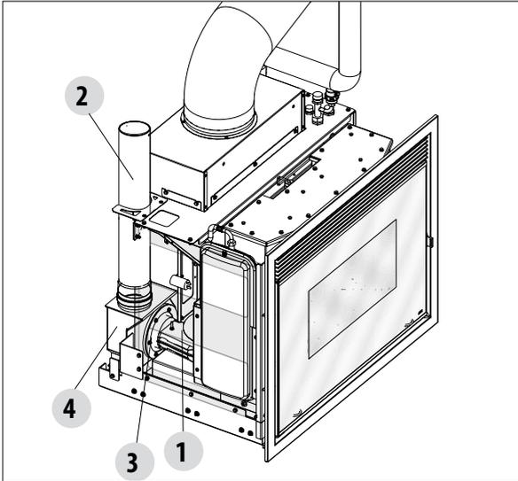
Dans la partie arrière/latérale du produit, au niveau de la sortie du ventilateur, on trouve le raccord de fumée avec son compartiment à cendres (4). Nettoyer aussi ce compartiment avec un aspirateur en enfilant le bec sur le trou d'insertion du ventilateur.
