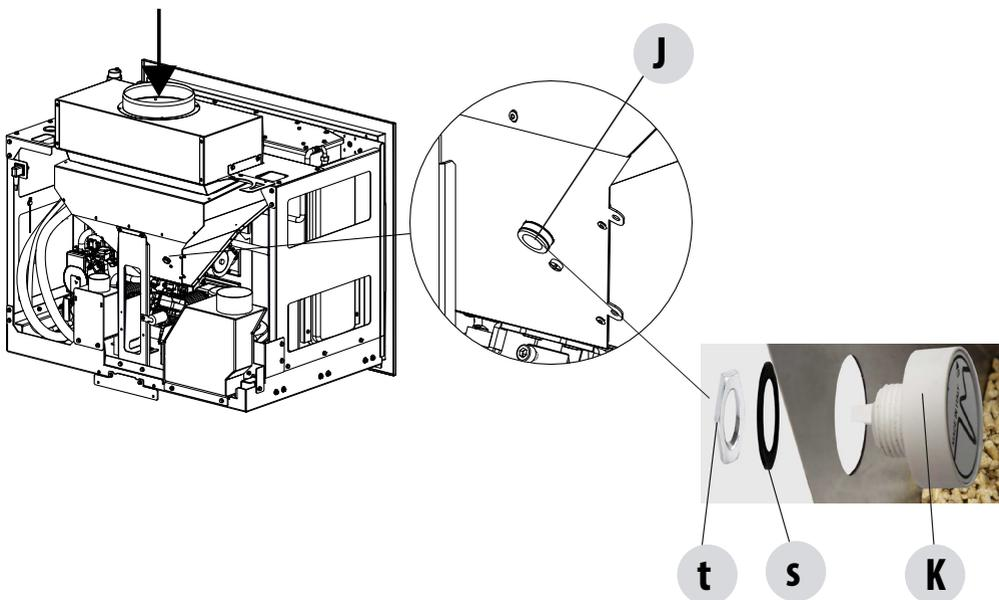
Le capteur des pellets est un indicateur de réserve du combustible afin d'avertir l'utilisateur que les pellets se terminent.
