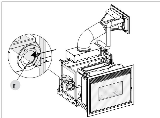
Il est conseillé d'aspirer aussi à proximité du raccord « r » et « k », et de démonter et nettoyer le ventilateur des fumées « L ».
