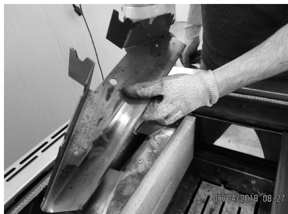
Fig. 64 - Retirer le profil
