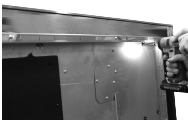
Fig. 74 - Retrait des vis
