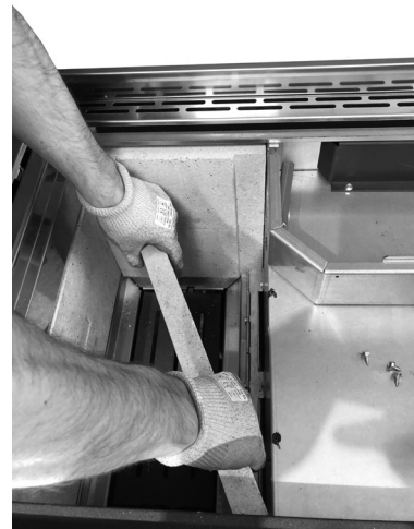
Fig. 70 - Retirer le matériau réfractaire
