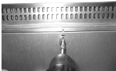
Fig. 19 - Ôter/desserrer les vis
