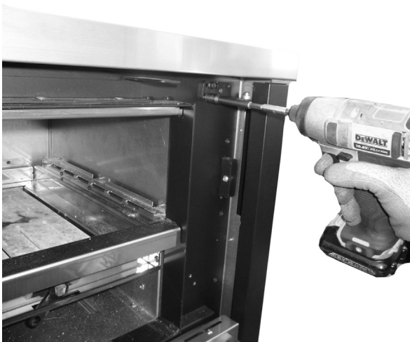
Fig. 25 - Fixer l'étrier supérieur
