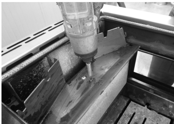
Fig. 63 - Retirer les vis
