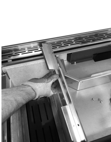
Fig. 69 - Retirer le profil
