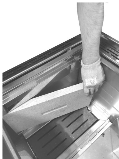
Fig. 72 - Retirer le profil
