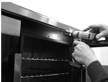
Fig. 73 - Retrait des vis
