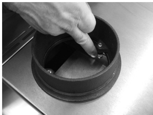
Fig. 51 - Fixer le tuyau
