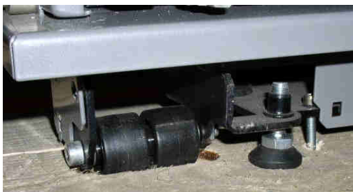
Fig. 6 : roulettes et pieds de réglage gauche
