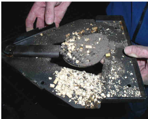
Fig. 128 : retirer la grille pivotante du support
