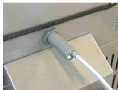
Fig. 63 : capteur de niveau installé
