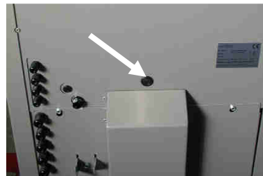
Fig. 62 : ouverture d'installation avec obturateurs
