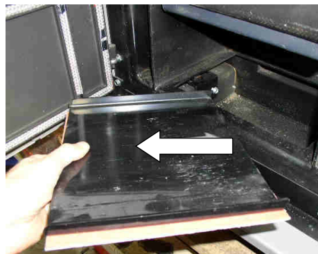
Fig. 108 : cache de l'accumulateur des gaz de combustion
