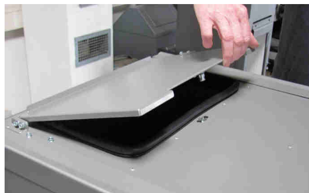
Fig. 87 : ouverture du réservoir à pellets BM01-2 ivo.safe
