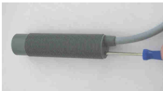
Fig. 69 : régler la sensibilité
