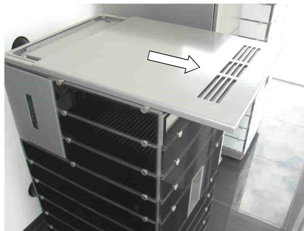
Fig. 86 : glisser le couvercle de l'appareil BM01 "ivo.tec"
