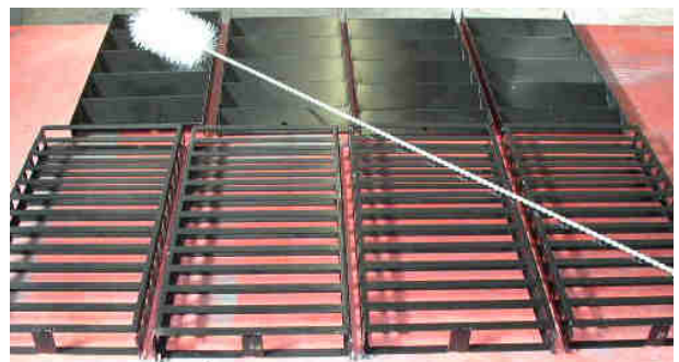
Fig. 141 : turbulateurs et râteliers de l'échangeur thermique
