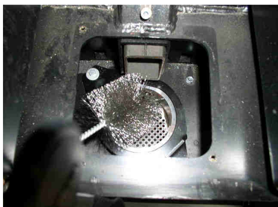
Fig. 122 : nettoyer la grille pivotante
