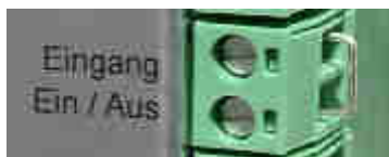
Fig. 51 : entrée Marche / Arrêt
