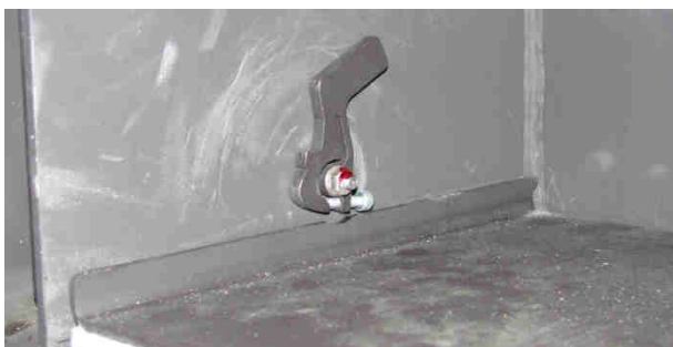
Fig. 107 : dispositif d'arrêt cache ouvert
