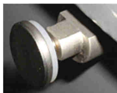
Fig. 27 : boulon de retenue aplati
