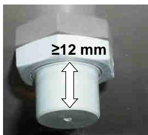
Fig. 64 : profondeur d'installation capteur de niveau
