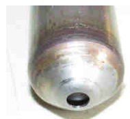
Fig. 132 : sortie d'air élément d'allumage ZP 7
