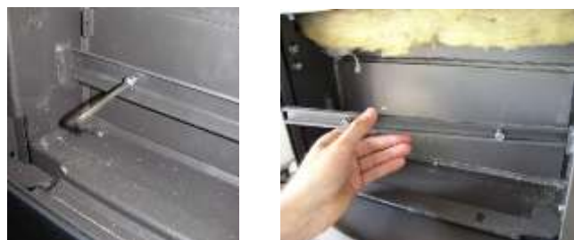
Fig. 34 : démontage du profilé en U
