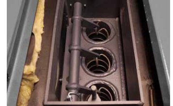
Fig. 6 : Tubes échangeur de chaleur avec turbulateurs
