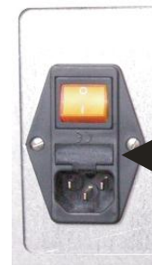
Figure 18 – Interrupteur avec compartiment pour fusibles
