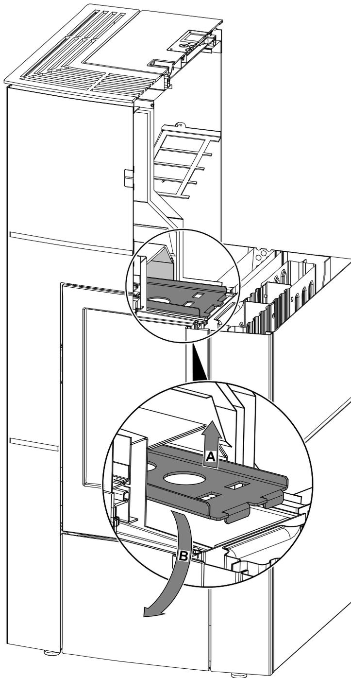
Illustration 1: démontage de la plaque déflectrice
