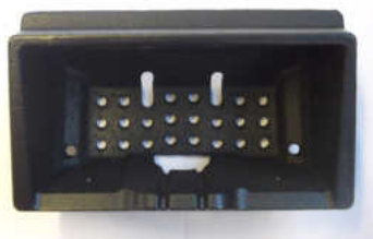
EXEMPLE DE BRASIER PROPRE
