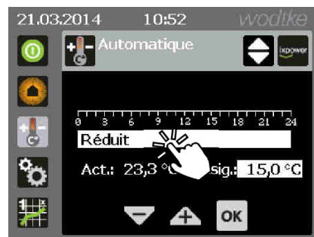
Fig. 19 : programme de chauffage réduction permanente
