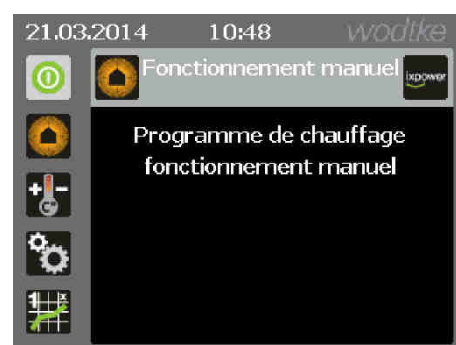
Fig. 10 : écran d'état programme de chauffage fonctionnement manuel
