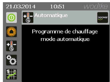
Fig. 13 : écran d'état programme de chauffage automatique
