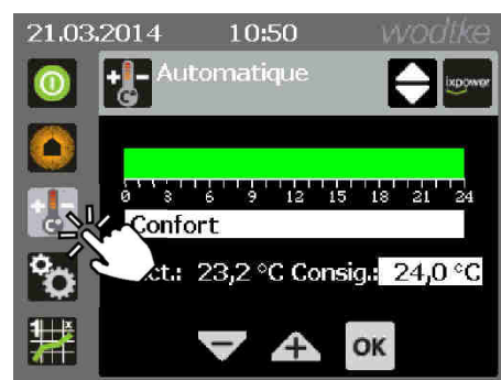
Fig. 11 : menu principal mode de chauffage automatique
