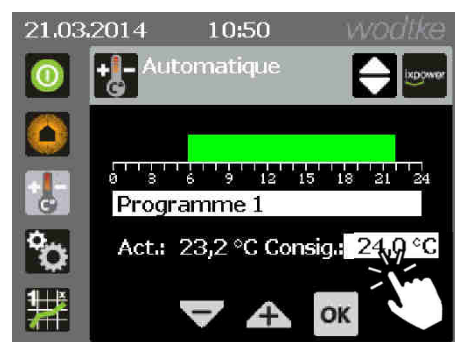
Fig. 14 : menu principal chauffage automatique
