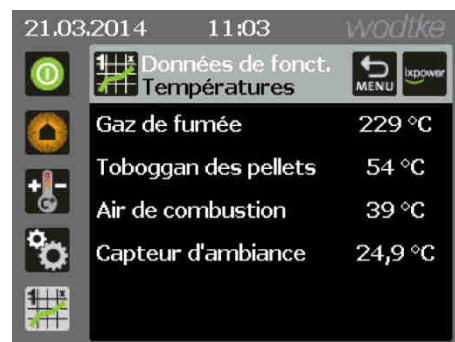
Fig. 55 : menu données de fonctionnement températures
