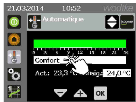
Fig. 18 : programme de chauffage confort permanent
