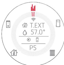
Dans le cas de la configuration d'installation 5/6, par contre, l'affichage peut être le suivant car NTC1 n'est plus active
