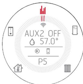
**AUX 3 = Contact en température.** C'est la température d'eau souhaitée au-delà de laquelle l'état du relais sur les contacts 7/8/9 change.
