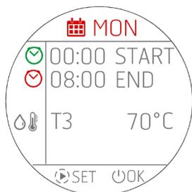
Par rapport aux produits AIR, il y a moins de configurations possibles, il n'y a que START, END et la température de l'eau dans la chaudière, le ballon tampon, le chauffe-eau.
