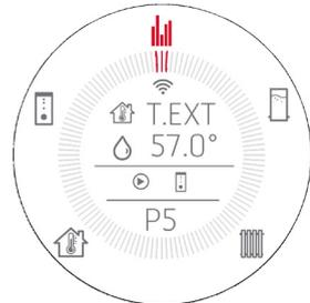
**AUX 2 = Pompe Ballon tampon activable dans** configuration INSTALLATION SET 5 e 6. Commande à distance d'une pompe externe en fonction de la température ambiante réglable depuis le panneau. Si la température ambiante est satisfaite, le relais de la vanne 3 voies qui transporte le courant vers le connecteur 10/11/12 change d'état.
