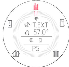
**AUX 1 = Alarme à distance.** En cas d'alarme du poêle, il inverse l'état du relais sur les contacts 7/8/9. L'affichage sur la première ligne est standard en fonction de ce qui est sélectionné sur NTC1 bien que cette configuration soit allumée en arrière-plan
