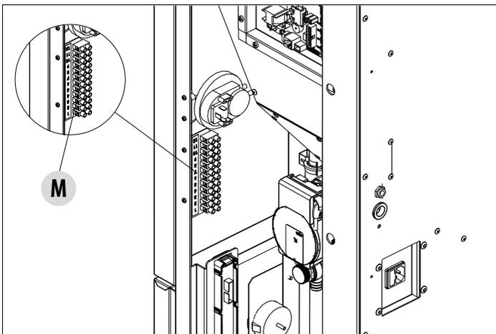
Les sondes NTC doivent être du type 10 K  $\Omega$  B3435, les thermostats doivent avoir le contact sec.
