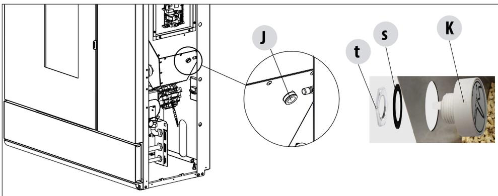
Le capteur des pellets est un indicateur de réserve du combustible qui sert à avertir l'utilisateur que les pellets sont en train de s'épuiser.
