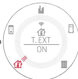
En cas de réglage d'une configuration AUX (2-3 voir chap. « Menu Utilisateur »), pour configurer la température du contact AUX présent sur NTC1, utiliser toujours la page-écran relative à la configuration de la température ambiante où il est affiché :
