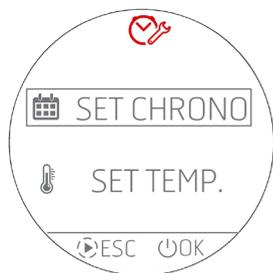
Pour configurer les températures de SET T1 – T2 – T3 – T4 (T3 et T4 uniquement pour les poêles Hydro), il faut entrer dans le menu **SET TEMP** en sélectionnant la rubrique avec les touches  $\oplus$   $\ominus$  et en confirmant avec la touche  $\odot$  OK.
