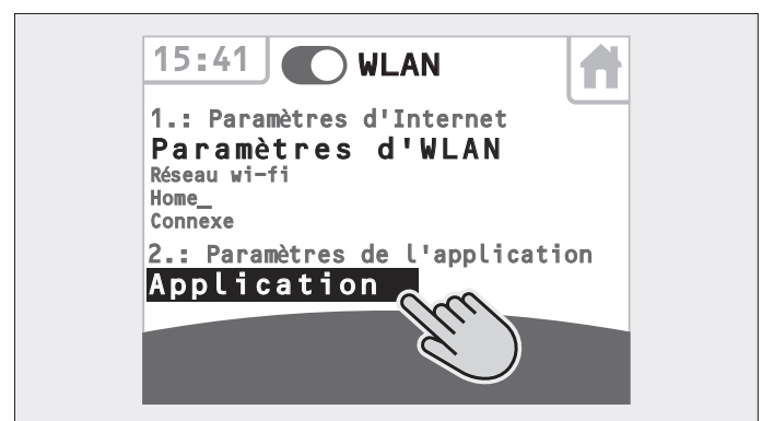
Fig. 3.44 En cas de réseau Wi-fi existant, sélectionner les paramètres de connexion à l'application
