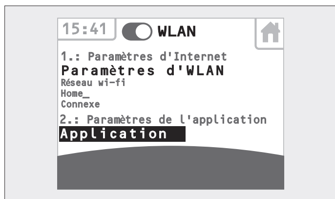
Fig. 3.33 Panneau de commande tactile – Accès au Wi-fi activé
