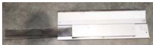
Schuif jaarlijks een nieuw gaas in het deksel van de remplaat Glisser tout les ans un nouveau treillis dans le couvercle déflecteur
