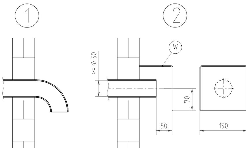
**Illustration 3: Protection contre le vent d'une amenée d'air**
