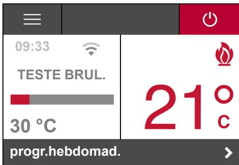
Avant le début de la phase de un **"test du brûleur"** est effectué automatiquement.
