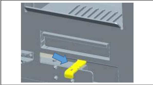
Fig. 12 : position manette d'admission d'air secondaire
