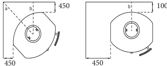
In dem Fall wo zur Wand kein Sicherheitsabstand einzuhalten ist, empfehlen wir zwischen 7 und 10 cm, damit der Ofen seine Strahlung verteilen kann und man auf der Hinterseite staubsaugen kann.
