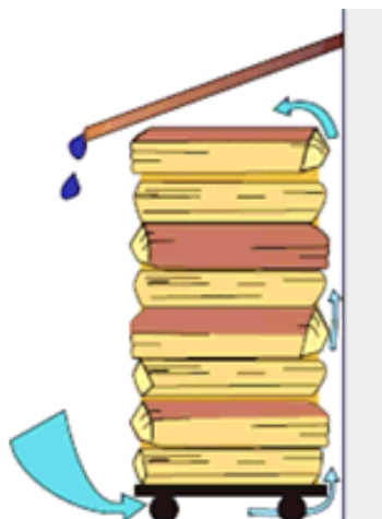
EXEMPLE DE STOCKAGE DU BOIS
