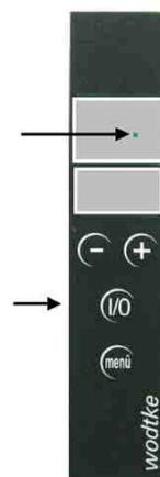
Après le raccordement correct et l'établissement de la liaison avec l'alimentation en courant, l'affichage devrait indiquer "G OFF", pour soufflerie d'arrêt, ou le point "en attente" (si la soufflerie d'arrêt ne fonctionne plus). L'affichage du point "en attente" en haut à droite signifie que l'appareil est débranché. Le mode automatique est impossible dans cet état de service.
