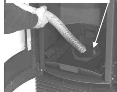
Fig. 36 : nettoyage support du pot
