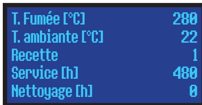
« **Service** » indique les heures de fonctionnement jusqu'au prochain service nécessaire à effectuer par un technicien de service qualifié ( → chapitre 12 ).
