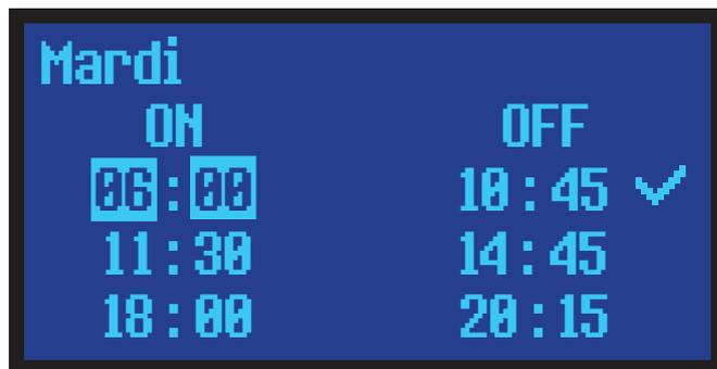
Une coche apparait à droite de l'heure de mise en marche/d'arrêt sélectionnée pour indiquer que cette heure de mise en marche/d'arrêt est maintenant active.
