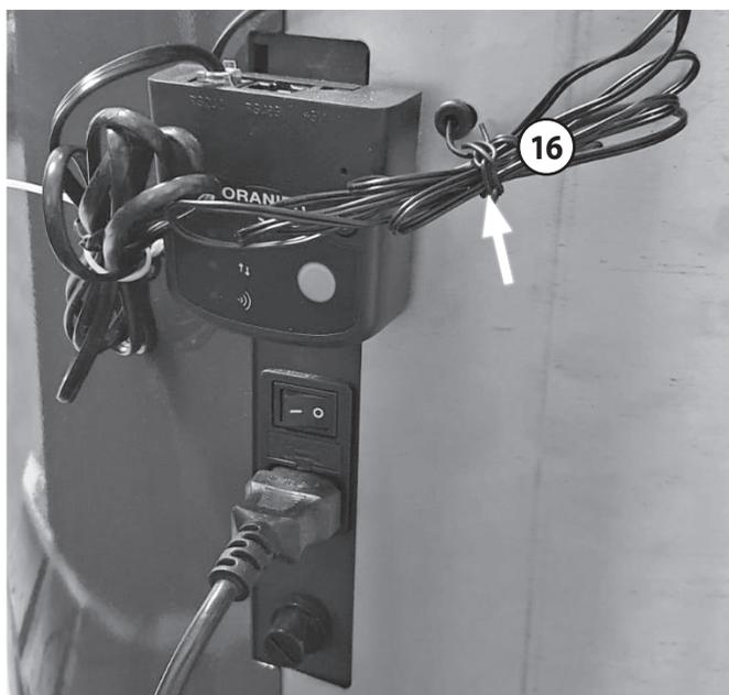
**i** La **sonde de température ambiante (16)** est placée à l'arrière de l'appareil.
