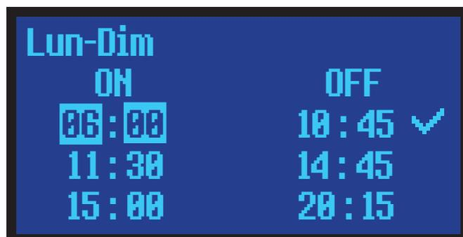
Une coche apparaît à droite de l'heure de mise en marche/d'arrêt sélectionnée pour indiquer que cette heure de mise en marche/d'arrêt est maintenant active.
