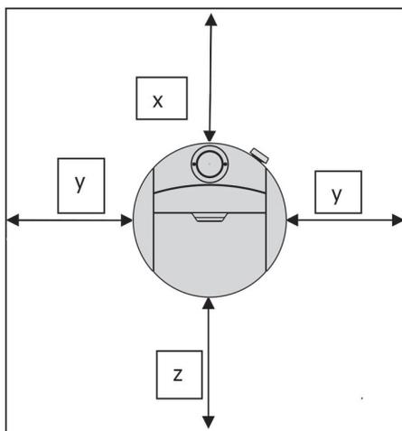
Outre les distances de sécurité normalement imposées, il doit être possible d'effectuer les travaux normaux de nettoyage et d'entretien. Pour ces travaux de maintenance et de nettoyage, il convient de respecter les distances minimales suivantes :
