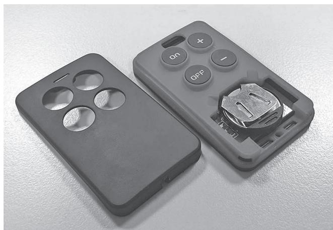
**i** Veuillez bien mémoriser la position de montage des piles bouton usagées. Pour que la télécommande puisse fonctionner, les piles neuves doivent être montées dans la même position.
