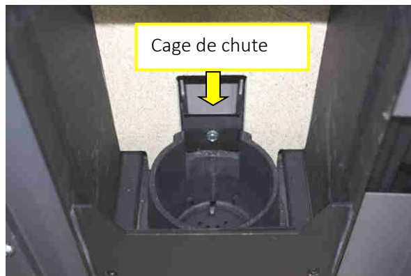
Fig. 66 : cage de chute des pellets
