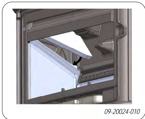
Vermiculite tagliafiamma SX in alto 03.77713.000
