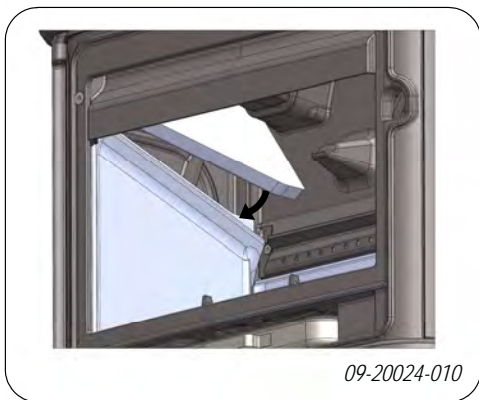
Défecteur supérieur D en vermiculite, réf. 03.77713.000
