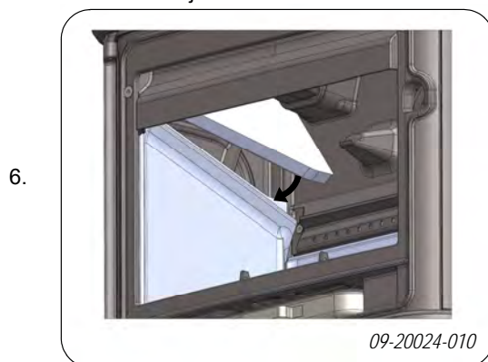
Vermiculiet Vlamplaat R boven 03.77713.000
