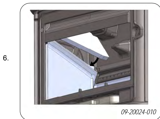
Vermiculit-Seitenwand L oben 03.77712.000
