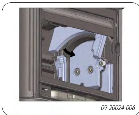
Pared lateral de vermiculita D (R) superior 03.77711.000
