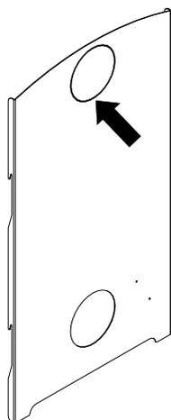
Abb. 22: Perforierten Ausschnitt entfernen
