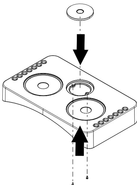
Abb. 27: Abdeckung am Deckel montieren
