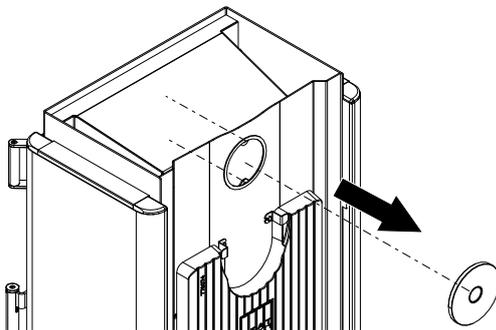
Abb. 24: Abdeckung demontieren
