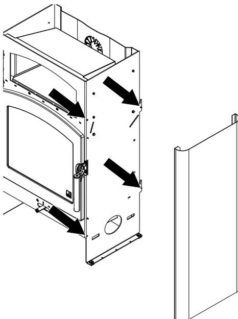
Abb. 10: Seitenverkleidung montieren
