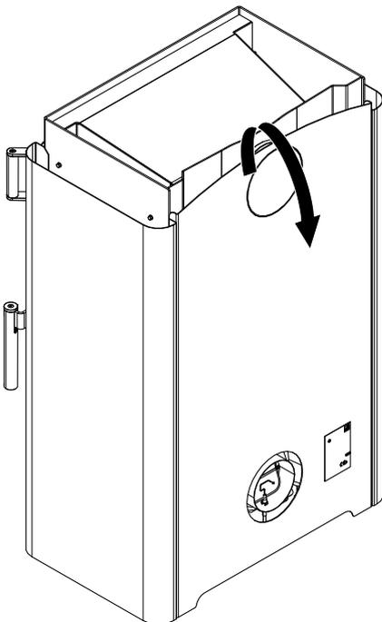
Abb. 40: Rückwand nach oben heben und entfernen
