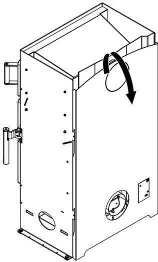
Abb. 8: Rückwand nach oben heben und entfernen
