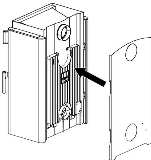
Abb. 26: Rückwand einhängen
