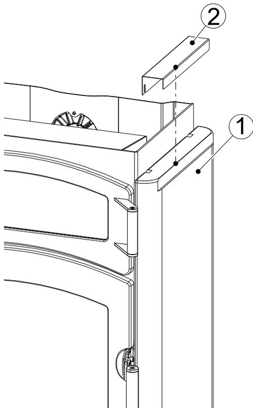
Abb. 15: Specksteinseitenverkleidung einhängen
